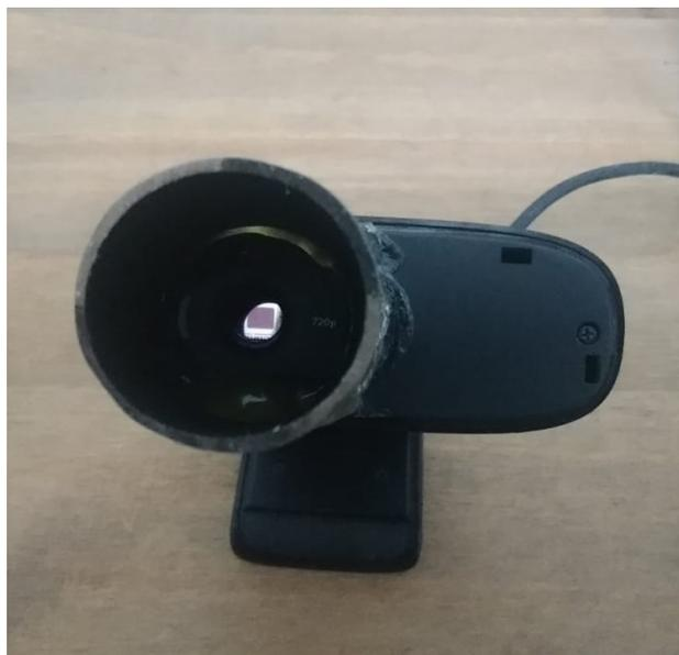
**Figura 3:** Webcam utilizada e sua CCD centralizada
