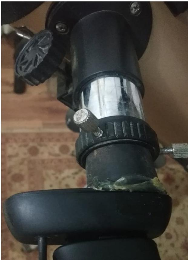
**Figura 4:** Webcam acoplada no telescópio
