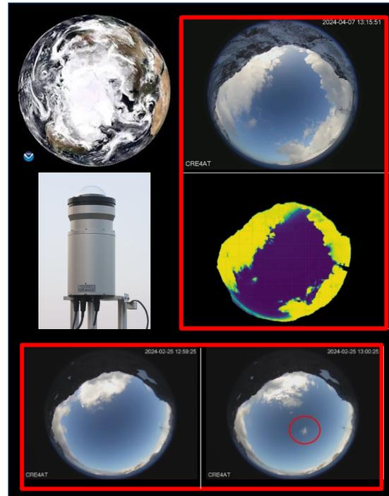
**Figura 8:** Acima, fotos de nuvens tiradas a partir de satélite e a partir do sistema de imageamento terrestre instalado na EACF. No centro, equipamento de CCD *all-sky* utilizado e registro processado pela IA. Abaixo, fotos de um evento de nuvens convencional seguido da identificação de uma nuvem embrionária, na EACF.
