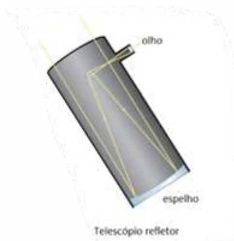
Figura 2: Esquema simplificado telescópio refletor. Elaborado pelos autores.
