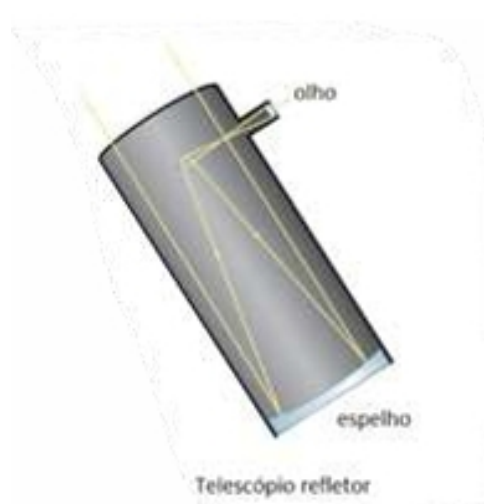
Figura 2: Esquema simplificado de um telescópio refletor. Elaborado pelos autores.
