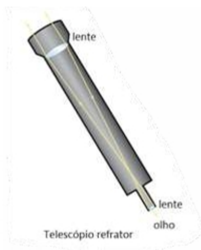
Figura 1: Esquema simplificado de um telescópio refrator. Elaborado pelos autores.
