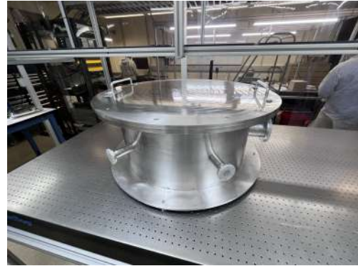
Figura 3: Câmara de vácuo utilizada na infraestrutura experimental da Universidade da Califórnia, Riverside (UCR), registrada durante a fase inicial de instalação e preparação do sistema. A imagem ilustra parte da estrutura desenvolvida para a realização dos experimentos acompanhados e executados pela autora durante sua permanência no laboratório.
