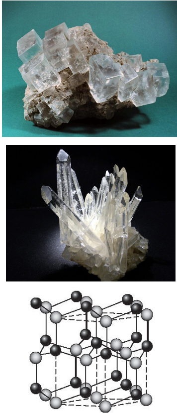
Figura 3: Cristais de sal comum NaCl , de quartzo SiO_2 e um exemplo de retículo cristalino ( SiO_2 - wurtzite). As forças interatômicas impõem as formas e a geometria dos corpos sólidos.
