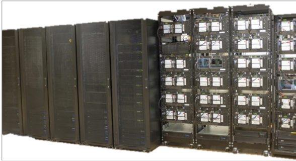
Figura 17: MIT é o famoso Massachusetts Institute of Technology e o MIT Correlator é um poderoso supercomputador que faz a correlação matemática bilhões de vezes por segundo entre os sinais dos pares de antenas que podem ser formados entre os 8 radiotelescópios do EHT . Crédito: Nancy Wolfe Kotary, MIT Haystack Observatory. Fonte: www.forbes.com/sites/tomcoughlin/2019/06/26/black-hole-data-processing-storage/#1d03f69b5bca .
