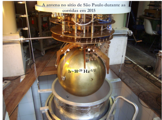
Figura 6: A antena ressonante esférica Schenberg no seu sítio na sala 107 do Laboratório de Estado Sólido e Baixas Temperaturas (LESBT), do Departamento de Materiais e Mecânica (DMM), no prédio Mário Schenberg do IFUSP (Foto tirada pelo autor).
