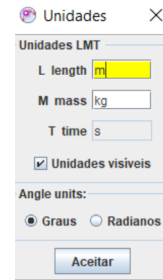
Figura 11: O campo em amarelo mostra onde deve ser substituída a unidade de medida de distância. Onde está m (correspondente a unidade de medida metro ) deve ser substituída para nm ( nanómetro ).
