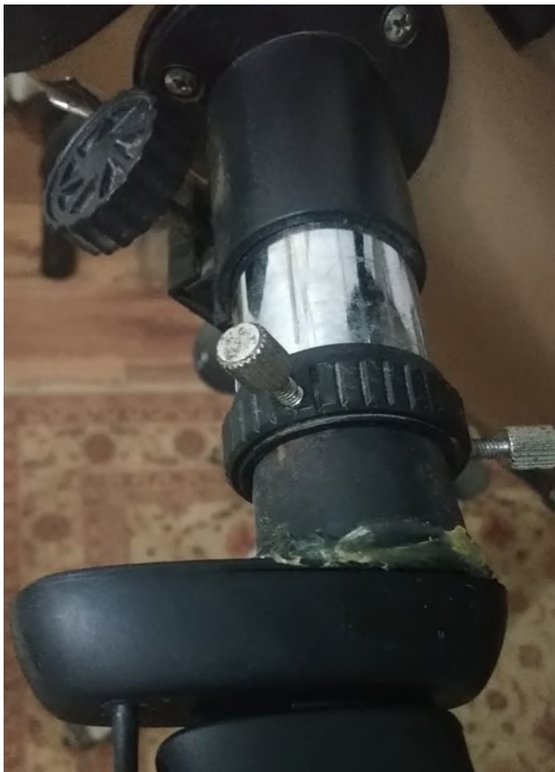
Figura 4: Webcam acoplada no telescópio
