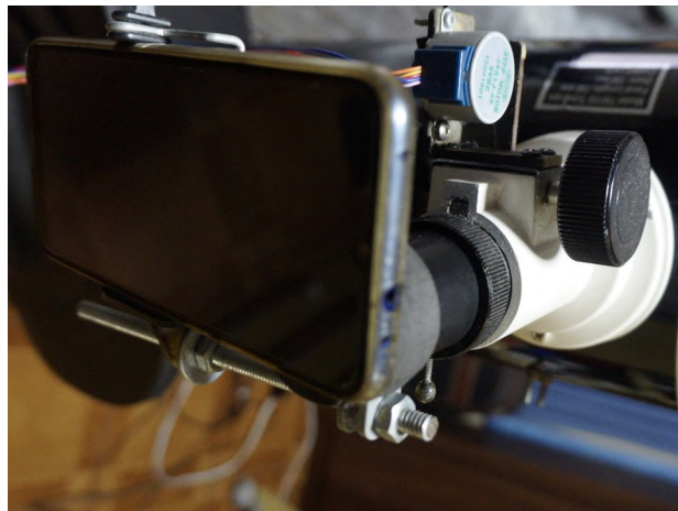
Figura 2: Celular acoplado no telescópio
