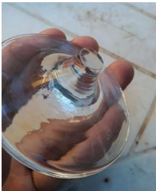
Figura 3: Lente de vidro semi-polida com rugosidades. Fonte: os autores.
