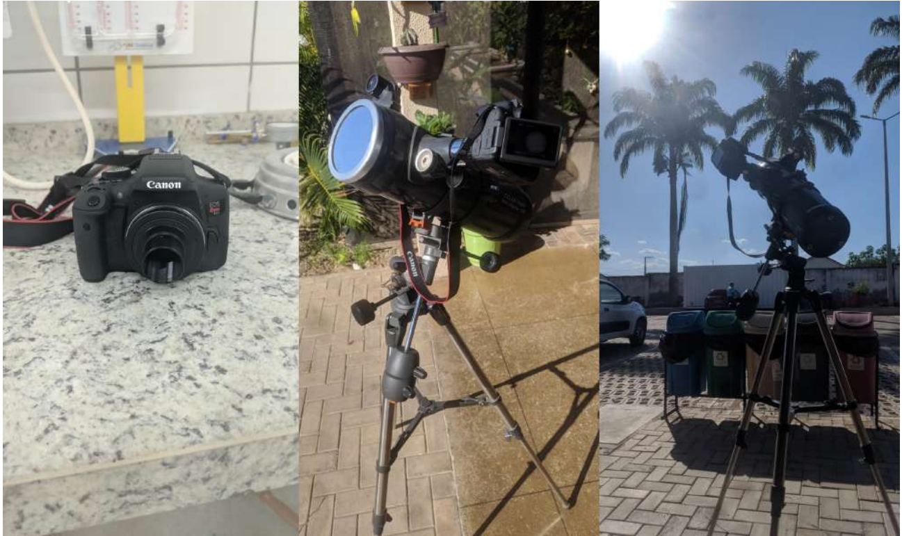
Figura 1: O processo de montagem da câmera no telescópio usando o método focal. À esquerda, câmera Canon EOS Rebel T6i com adaptador T-Mount no lugar da lente, ao centro, câmera acoplada ao telescópio e destacando o filtro solar, e à direita, telescópio alinhado e pronto para observação.
