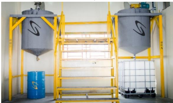
Figura 3a. Misturadores de 1000 Litros de Matéria Prima
