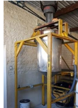
Figura 3b. Misturador de 250 kg de Matéria Prima
