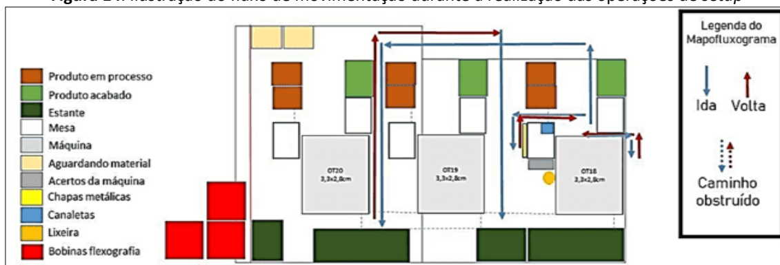
Figura 14. Ilustração do fluxo de movimentação durante a realização das operações de setup
