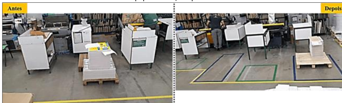
Figura 13. Realização da marcação no setor de corte para identificação e localização dos equipamentos/maquinários
