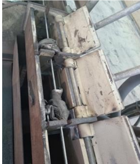
Figura 2. Imagem do removedor de carepa utilizado na indústria
