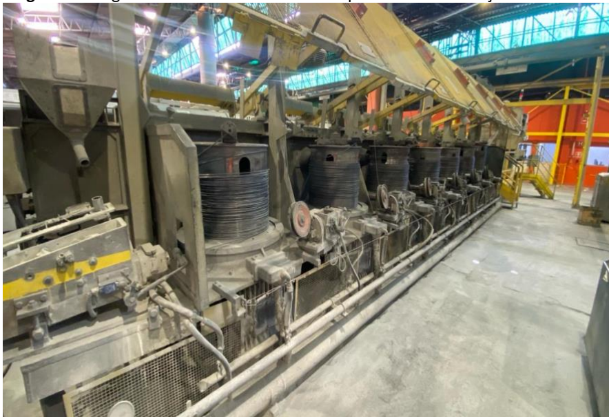
Figura 3. Imagem das fieiras e dos blocos do processo de trefilação na indústria
