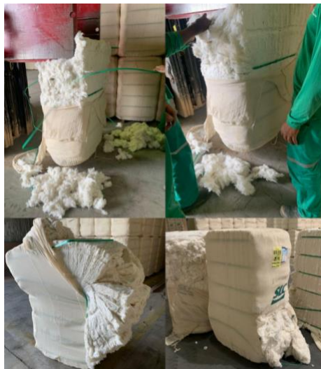
Figura 10. Fardos com fitas e sacos de tela rompidos
