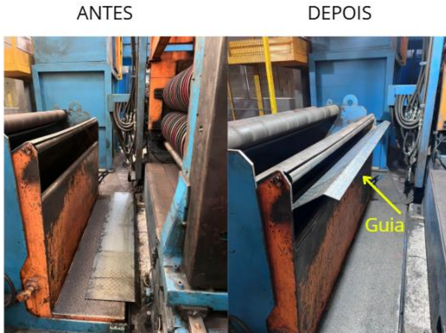
Figura 10. Instalação - antes e o depois - da instalação da guia de refilo na máquina
