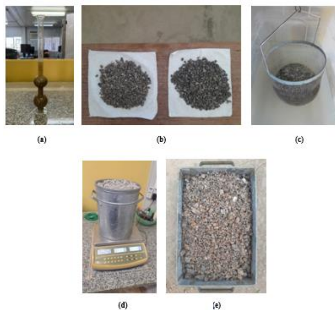
Figura 5. Caracterização dos agregados: (a) Massa específica agregado miúdo, (b) Absorção de água, (c) Massa específica do agregado graúdo, (d) Massa unitária agregado graúdo, (e) Ensaio Los Angeles
