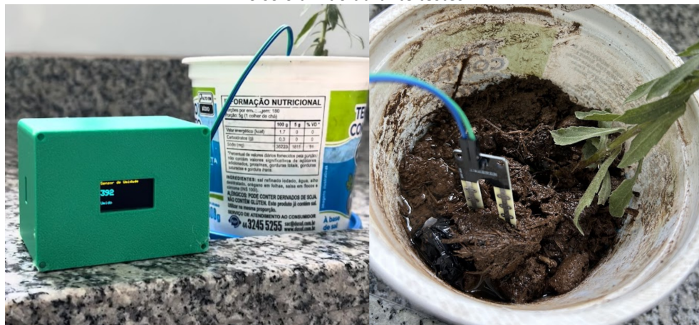
Figura 5. Protótipo IOT coletando informações relacionadas a umidade do solo e sensor em contato direto com o solo úmido durante testes
