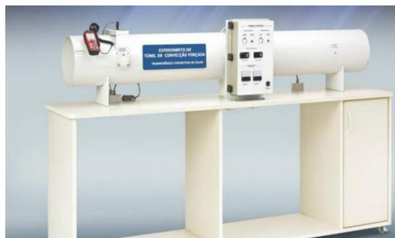
Figura 1 – Secador de convecção túnel de vento.
