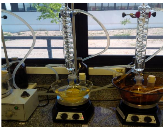
Figura 4: Aparato experimental das reações de transesterificação.
