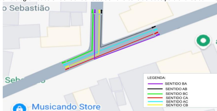
Figura 6. Esquema diagramático evidenciando rotas de fluxo consideradas para análise da influência dos PGTs
