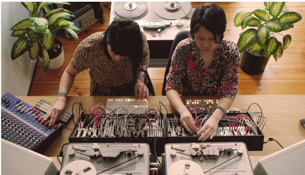
*cords*, um sistema de cabos que interliga partes dos módulos entre si para fechar um circuito que produza som. O *patch* corresponde ao conjunto dessas interligações, uma configuração de entradas e saídas que compõe um caminho específico para o sinal elétrico. É, portanto, um sistema complexo e como tal está sujeito à emergência.
