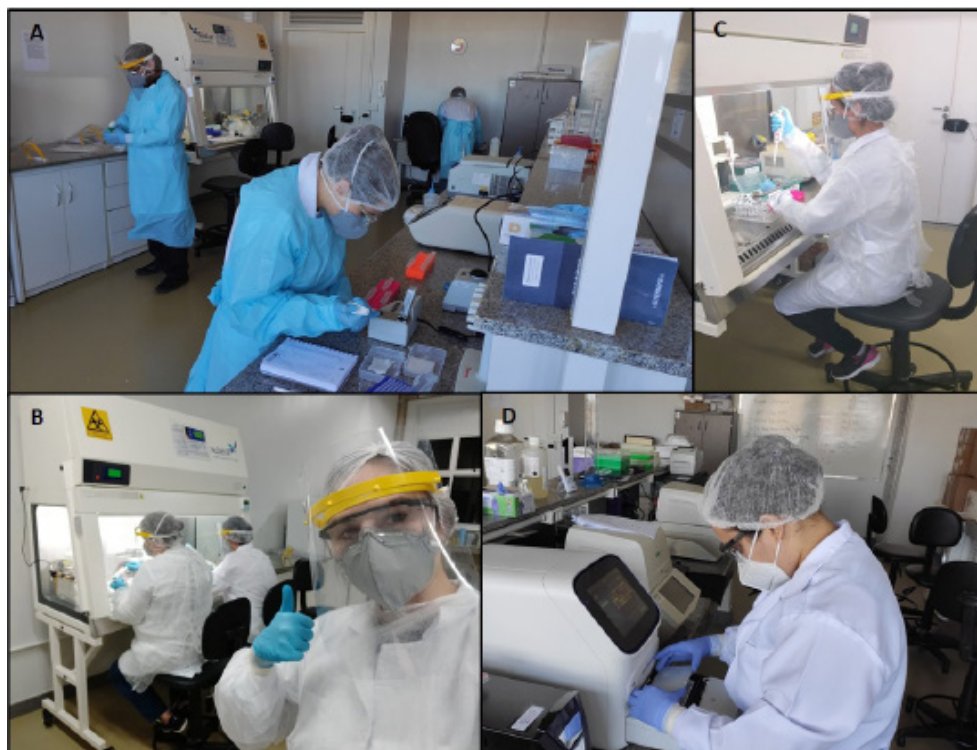
Figura 2: Equipe integrante do LDM durante as atividades de execução do teste diagnóstico da COVID-19 por RT-qPCR. (A) Recebimento e identificação das amostras. (B) Aliquotagem das amostras. (C) Extração do RNA. (D) RT-qPCR. (Fonte: Rubens Pasa – acervo pessoal, (2020/2021).
