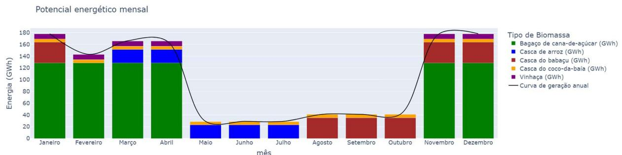
Figura 8. Potencial mensal de geração de energia elétrica através da biomassa.
