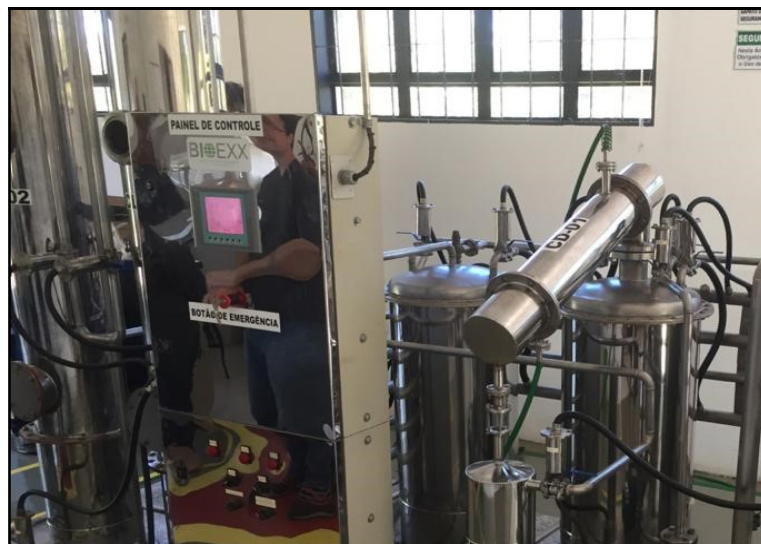
Figura 1. Planta piloto de produção de biodiesel a partir de óleos residuais (UNIARA).
