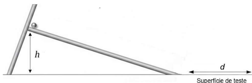
Figura 3. Aparato utilizado para medição do coeficiente de atrito de rolamento.
