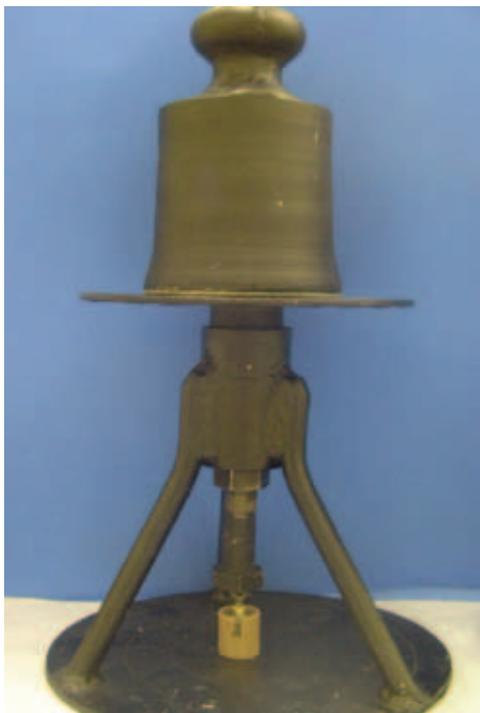
Figura 4 – Dispositivo para aplicação de peso constante de 5kg no longo eixo do corpo de prova
