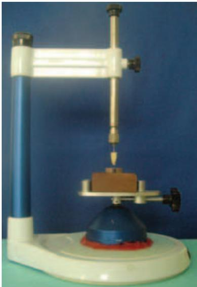
Figura 1- Raiça e tubo de PVC em posição no delineador. 1.base de madeira; 2. mesa porta-modelos; 3. haste móvel do delineador.
