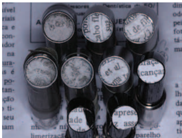
Figura 1 – Imagens de ponteiros de fibra óptica comprometidas para a transmissão da luz
