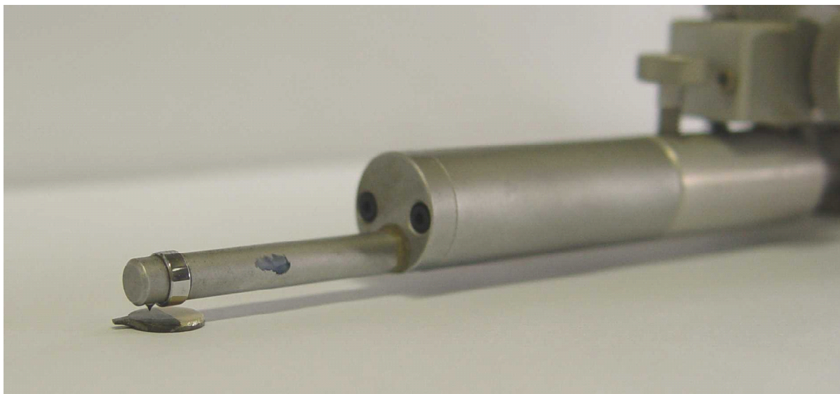
Figura 5 - Detalhe da ponta apalpadora do rugosímetro (SURFTEST 402, série 178 – Mitutoyo Co. – Japão), realizando a medição no corpo-de-prova
