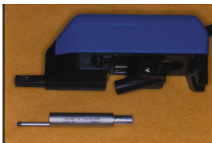
Figura 5 – Rugosímetro utilizado com a ponta do estilete que avalia a rugosidade
