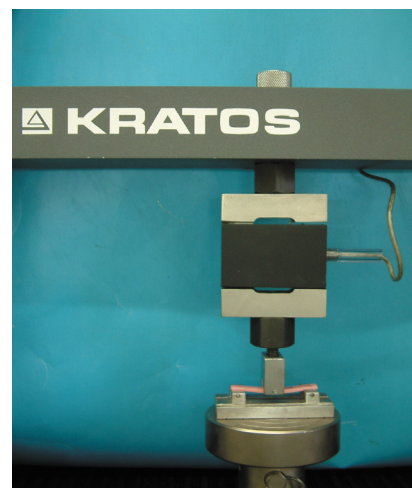
Figura 6 - Máquina Kratos utilizada para medição da resistência flexional
