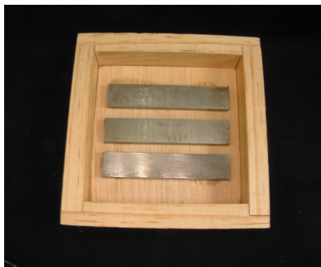
Figura 1 - Matrizes de alumínio presas na madeira
