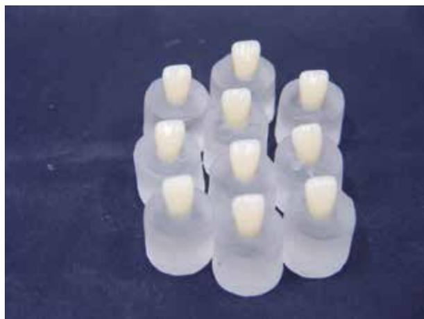
Figura 3: Dispositivo para ensaio mecânico de cisalhamento
