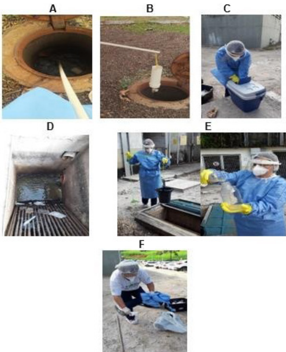
FIGURA 1. A: Ponto de coleta do esgoto do estabelecimento penal. B: Coletor utilizado durante as coletas no estabelecimento penal. C: Acondicionamento das amostras em caixa térmica apropriada. D: Ponto de coleta do esgoto do hospital universitário. E: Coletor utilizado durante as coletas no hospital universitário. F: EPIs utilizados durante as coletas. Fonte: Arquivo pessoal dos autores.
