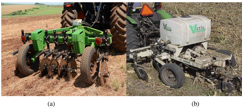
Figura 1 – Condutivímetro tratorizado – Veris (a) e sensor de condutividade elétrica e pH do solo (b). Fonte: Stara (a) e Veris Technologies (b).
