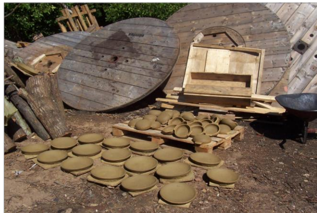
Foto 08: Secagem final – último estágio antes da queima e açoitamento
