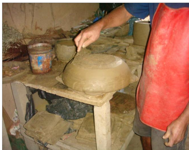
Foto 06: Etapa de raspagem
